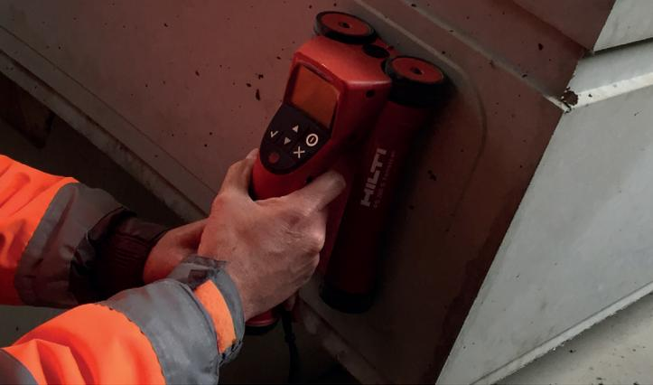
Hochwertiges Messgerät: Für die Betonüberdeckungsmessungen wird das Messsystem der Firma Hilti „Ferroskan PS 2005“ verwendet.
