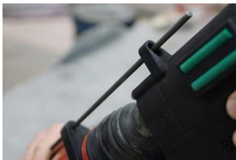
Über Tiefenanschlag der Bohrmaschine Verdrehsicherung sicherstellen.
