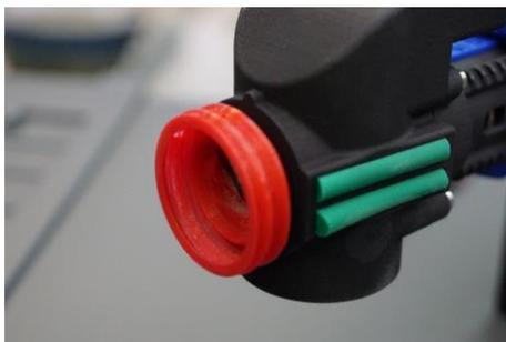
Dichtung mit den Fingern zusammendrücken und nach vorn abziehen. Neue Dichtung ebenfalls zusammendrücken und aufsetzen.
