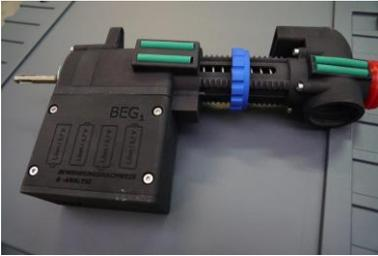
Die vier Schrauben an der Abdeckung des Akkufachs mit dem mitgelieferten Sechskant lösen.
