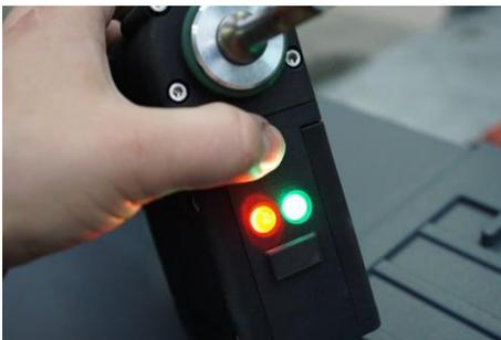
Wenn das Gerät einsatzbereit ist, leuchten die rote und grüne LED, ein Geräusch von der Pumpe ist zu hören und aus dem Bohrer strömt Luft.
