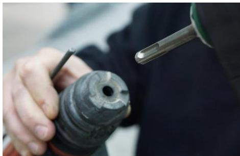
BEG<sub>1</sub> in handelsübliche Akku- oder netzbetriebene Schlagbohrmaschine mit SDS plus-Aufnahme einführen.
