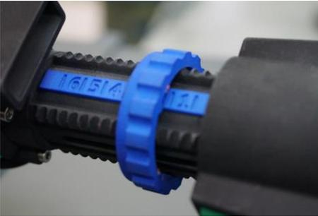
Anschlagring auf die gewünschte Tiefenstufenposition einstellen und nach rechts verriegeln.
