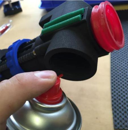
Den Bohrkopf bzw. das Gerät nach jeder Probeentnahme mit Druckluftspray reinigen.
